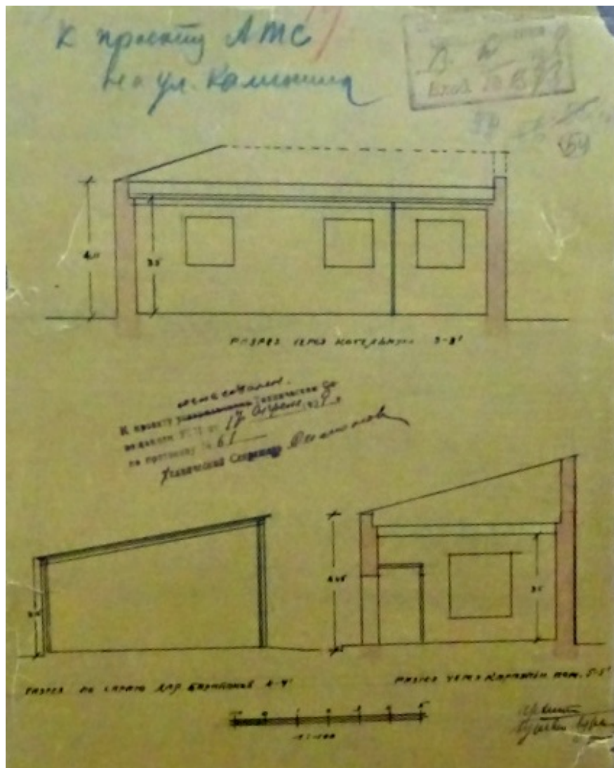
Илл. 19. Проект АТС. Разрез через котельную. Разрез по сараю для барабанов. Разрез через караульное помещение. Архитектор Гуревич – Гурьев. Согласован Техническим Собранием УГИ 17 апреля 1929 г. ЦГАНТД СПб. Ф. 192. Оп. 3-1. Д. 5760. Л. 54.
