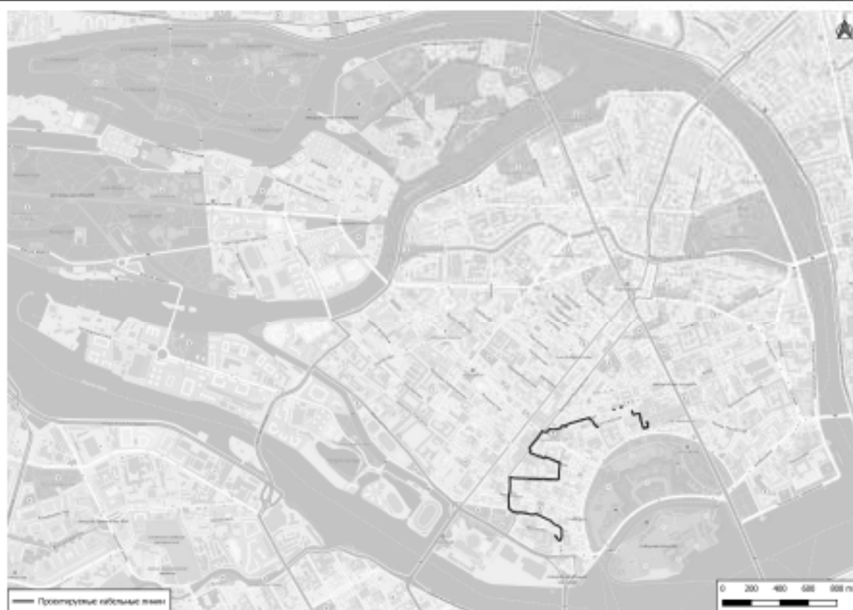
Рис. 2. «Реконструкция кабельных линий Петроградского района КЛ 0,4 кВ протяженностью 0,3 км, КЛ 6-10 кВ протяженностью 4,56 км». Проектируемые кабельные линии и ОКН «Провиантская улица (Мытный переулок) 1. Участок культурного слоя окрестностей Мытного двора города Санкт-Петербурга XVIII-XX вв.» на карте-схеме Петроградского района
