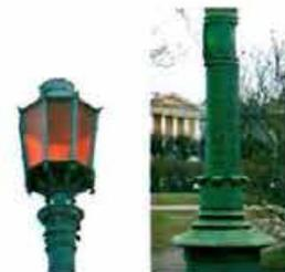
парковые фонари – габариты, конфигурация, историческое художественное решение (металлический столб, декорированный чугунными муфтами, на чугунном пьедестале, со светильником в виде стеклянного шара на чугунной розетке);
