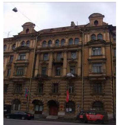
два эркера – местоположение (в уровне 3-4-го этажей), габариты, конфигурация; угловые каннелированные пилястры с лепным декором и капителями композитного ордера; междуэтажные профилированные карнизы – между 2-3-м, 3-4-м этажами; лучковые разорванные фронтоны; штукатурные фигурные кронштейны с гротескными маскаронами;
