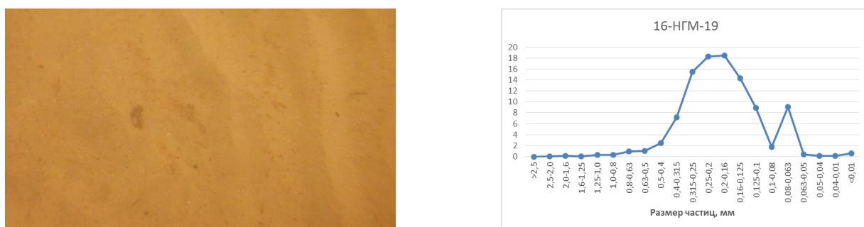
Рис. 4.2.23. Подводное фото и кривая распределения гранулометрического состава средне-мелкозернистых песков. Станция 16-НГМ-19.
