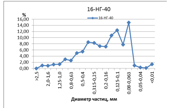
Рис. 4.2.20. Разнозернистый, существенно мелкозернистый песок (образец 16-НГ-40).
