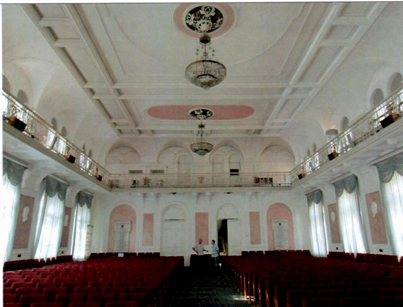
две двери, ведущие в актовый зал – местоположение, габариты, конфигурация, материал (дерево), конструкция (двухстворчатое, с полуциркулярной фрамугой), оформление (фрамуга на 6 стекол; каждая створка на 4 филенки);
