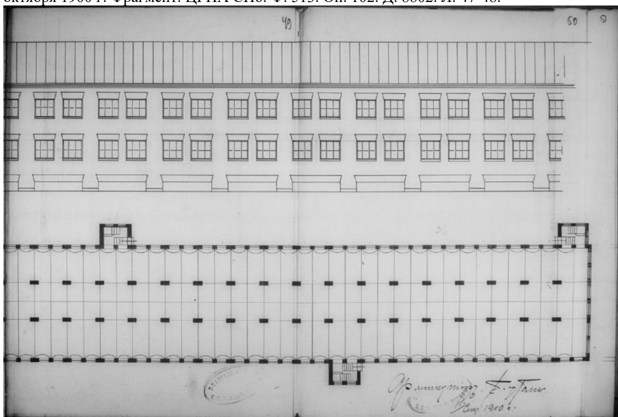
Илл.22. Продольный фасад заводского флигеля (канатный корпус) и планы 1 и 2 этажей. Чертеж составлен 11 сентября 1900 г. Архитектор Г.Г. фон Голи. Утвержден 20 октября 1900 г. Фрагмент. ЦГИА СПб. Ф. 513. Оп. 102. Д. 8802. Л. 49-50.
