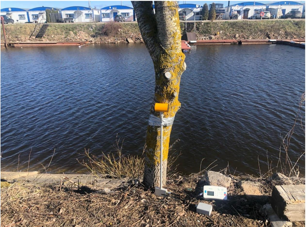
Рисунок 10. Магнитометр MiniMag
