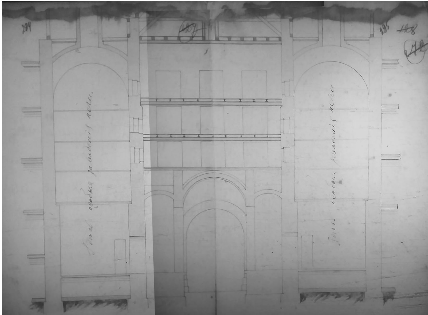
39. Проект разборки 10 дымовых труб в средней части солодовни и замены их новыми трубами с увеличением их высоты. Разрез центральной части здания. Гражд. инж. В. Бернгард. 1900 г. // ЦГИА СПб. Ф. 513. Оп. 102. Д. 6059. Лл. 294-195.
