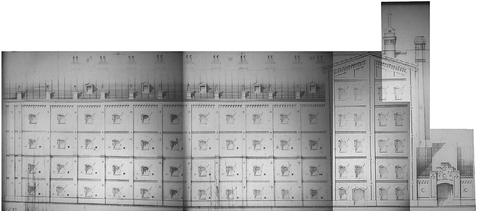
14. Проект солодовни, здания для паровых котлов и машин и заводской трубы. Южный (лицевой) фасад. Арх. Э.Г. Юргенс. 26 февраля 1875 г. // ЦГИА СПб. Ф. 513. Оп. 102. Д. 6059. Лл. 159-165.
