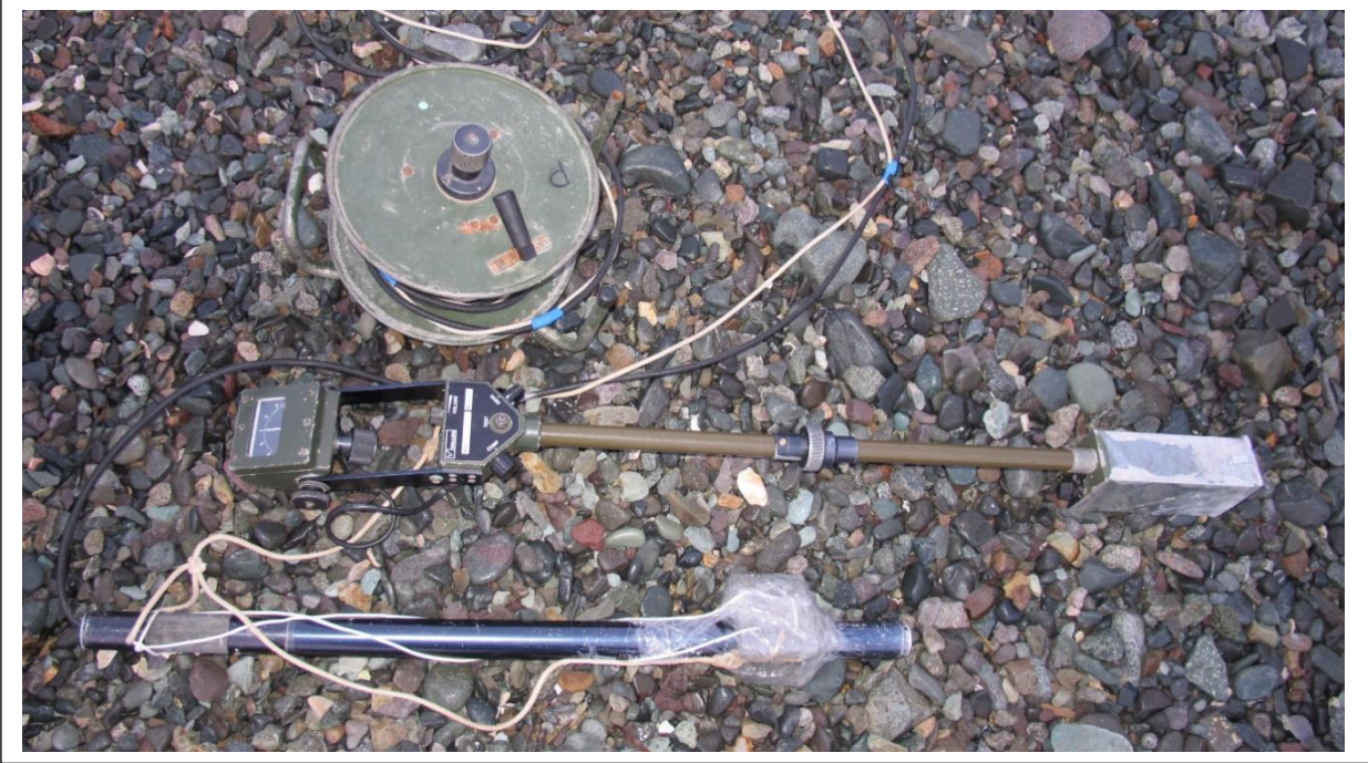
Рисунок 14: Прибор для уточнения местоположения ферромагнитной аномалии
