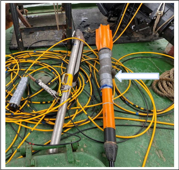
Рисунок 7: Морской магнитометр SeaSPY 2
