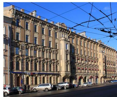
в уровне первого этажа ризалитов расположены прямоугольные дверные проемы парадных лестниц; перед ними - по одной ступени из красного гранита; заполнение дверных проемов\*: деревянные, двустворчатые, полусветлые двери с прямоугольными остекленными фрамугами, (\*заполнение проема по
