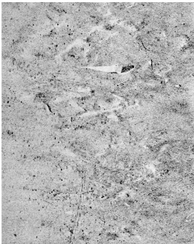
Рисунок 23. Пример изображения коренных пород на сонограмме
