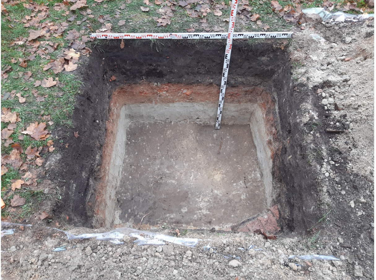
Рис. 31. Санкт-Петербург, земельный участок по объекту: «Дюкерный переход газопровода среднего давления с подводными газопроводами с Аптекарского острова на Каменный остров». Шурф 1. Фотофиксация по уровню темно-коричневой супеси (погребенной почвы). Вид на юг.
