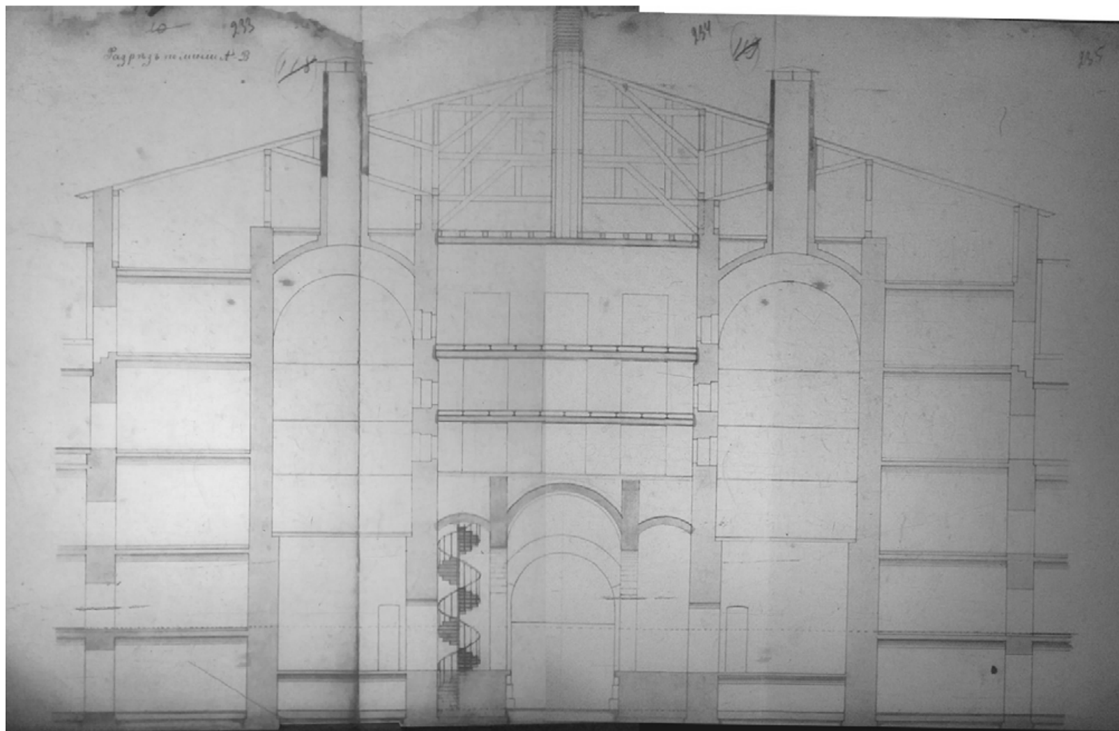
29. Проект пристройки центрального объема солодовни. Продольный разрез. Гражд. Инж. В. Бернгард. 1888 г. // ЦГИА СПб. Ф. 513. Оп. 102. Д. 6059. Лл. 233-235.
