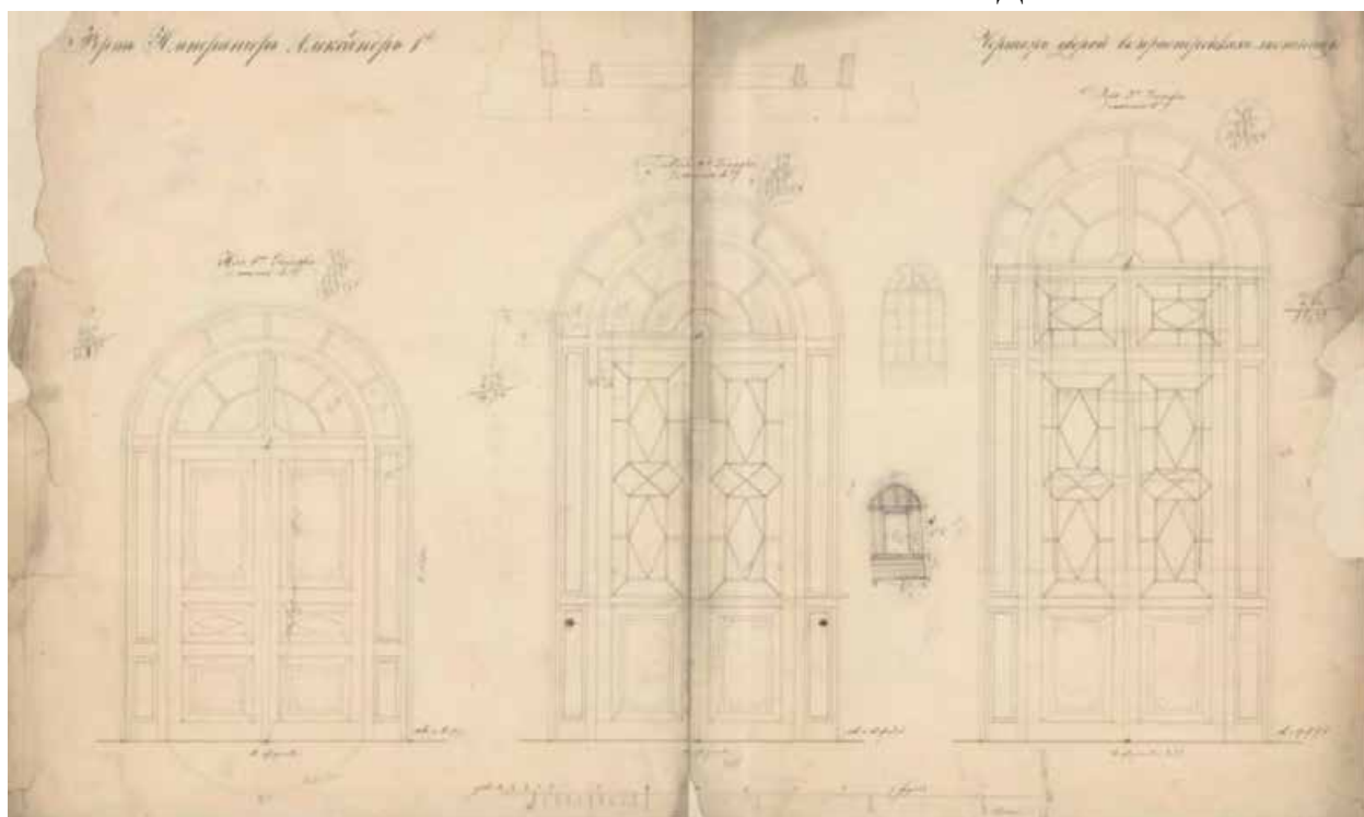
Илл. 66. Форт Император Александр I. Чертеж дверей в пристройках лестниц. 1856 г. // РГАВМФ. Ф. 1341. Оп. 4. Д. 2684.
