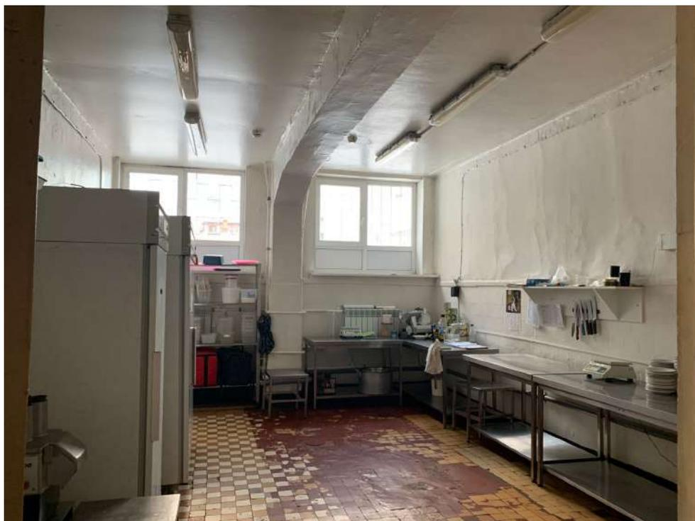
*Фото №51 Общий Вид на помещение Холодный цех. Наблюдаются трещины и пухтение штукатурного слоя на стенах и потолке*
