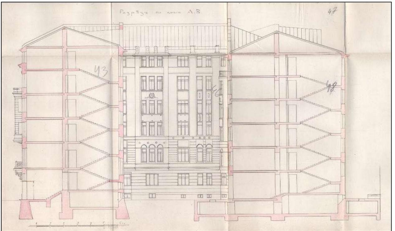
19. Разрез по линии АВ дома акционерного общества «Строитель»
