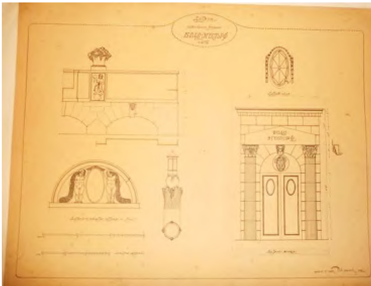
Илл. 14. Проект павильона Бодо Эггесторф. Архитектурные детали фасадов. Чертежи входного портала, окна, аттика, фонаря. Гражданский инженер Л. А. Ильин. 1908 г. Архив ФГБУК «Государственный научно-исследовательский музей архитектуры имени А. В. Щусева». ГНИМА ОФ-1072/392.
