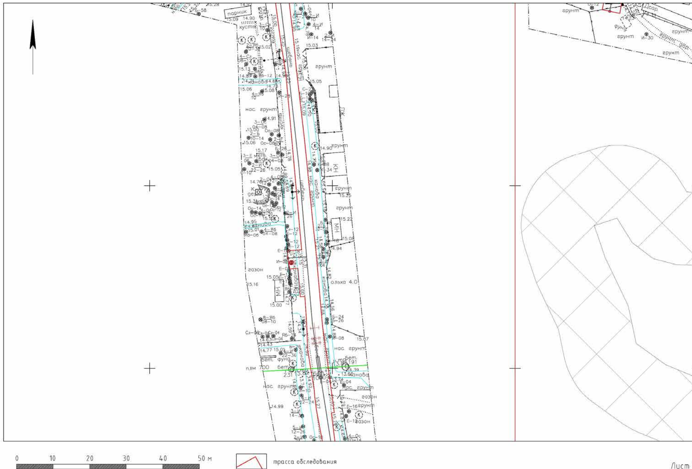
Рис. 27. Санкт-Петербург, Д. Рыбацкое. Топографический план трассы обследования с точками съемки общих видов и расположением шурфов.
