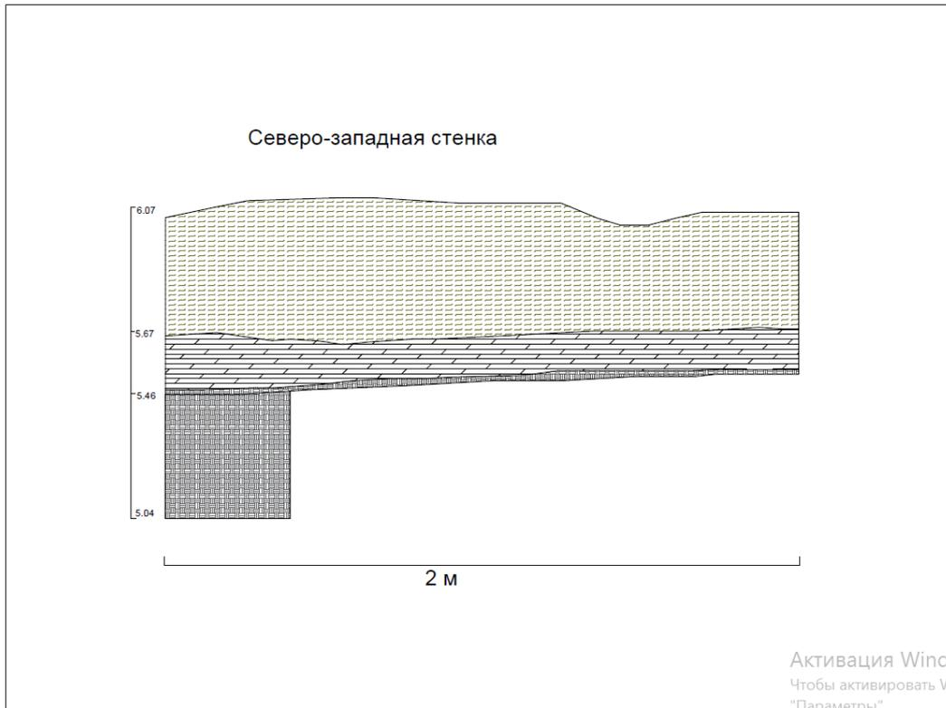
Рис. 39. СПб-2022. Невский район, «Проектирование реконструкции системы водоснабжения кварталов 6, 6А СУН (севернее улицы Новоселов) Невского района. Изменение проектных решений». Шурф 1. Чертежи. Стратиграфия с/з стенки.
