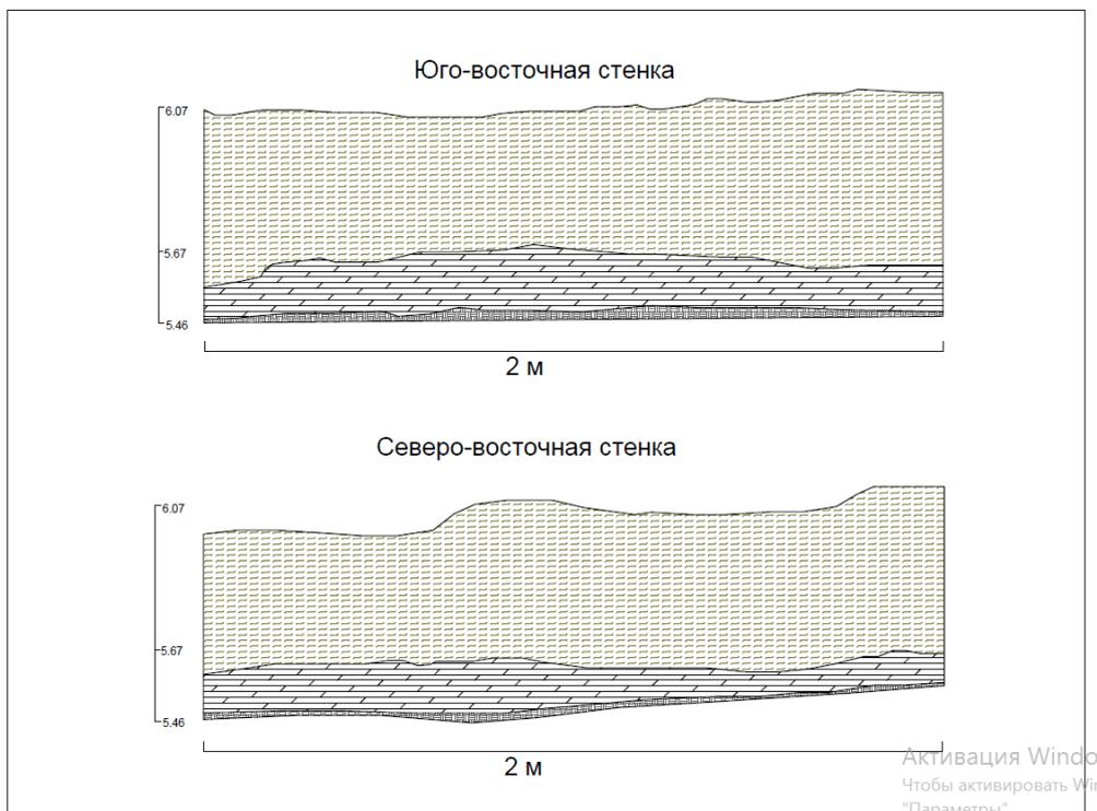
Рис. 38. СПб-2022. Невский район, «Проектирование реконструкции системы водоснабжения кварталов 6, 6А СУН (севернее улицы Новоселов) Невского района. Изменение проектных решений». Шурф 1. Чертежи. Стратиграфия с/в и ю/в стенок.
