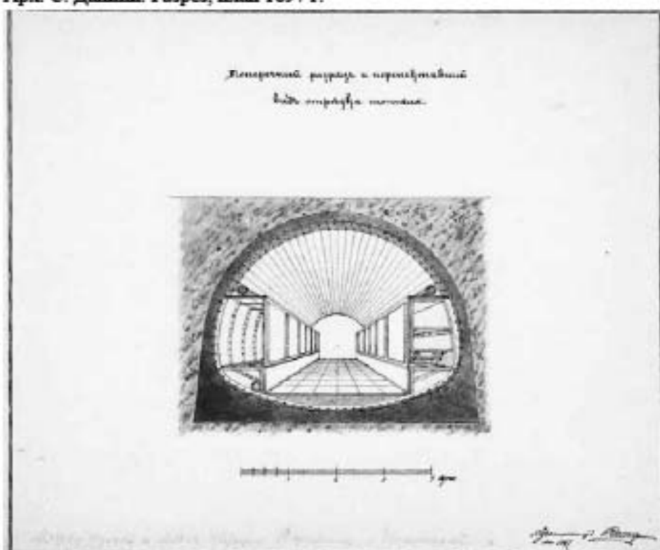
Илл. 12. Тоннель между Александровским дворцом и Кухонным корпусом, арх. С. Данини. Поперечный разрез, 1897 г.
