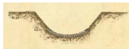
разрез исторического канала
