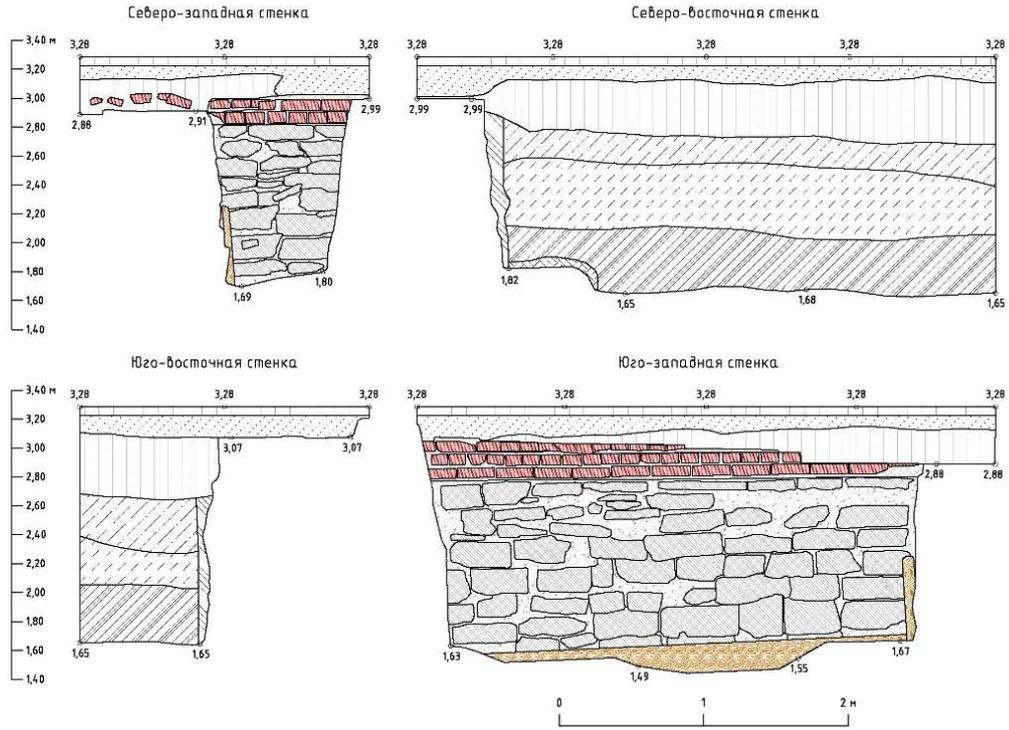
Рис. 51. Санкт-Петербург, Инструментальная улица, дом 3. Шурф 2. Чертежи стенок шурфа
