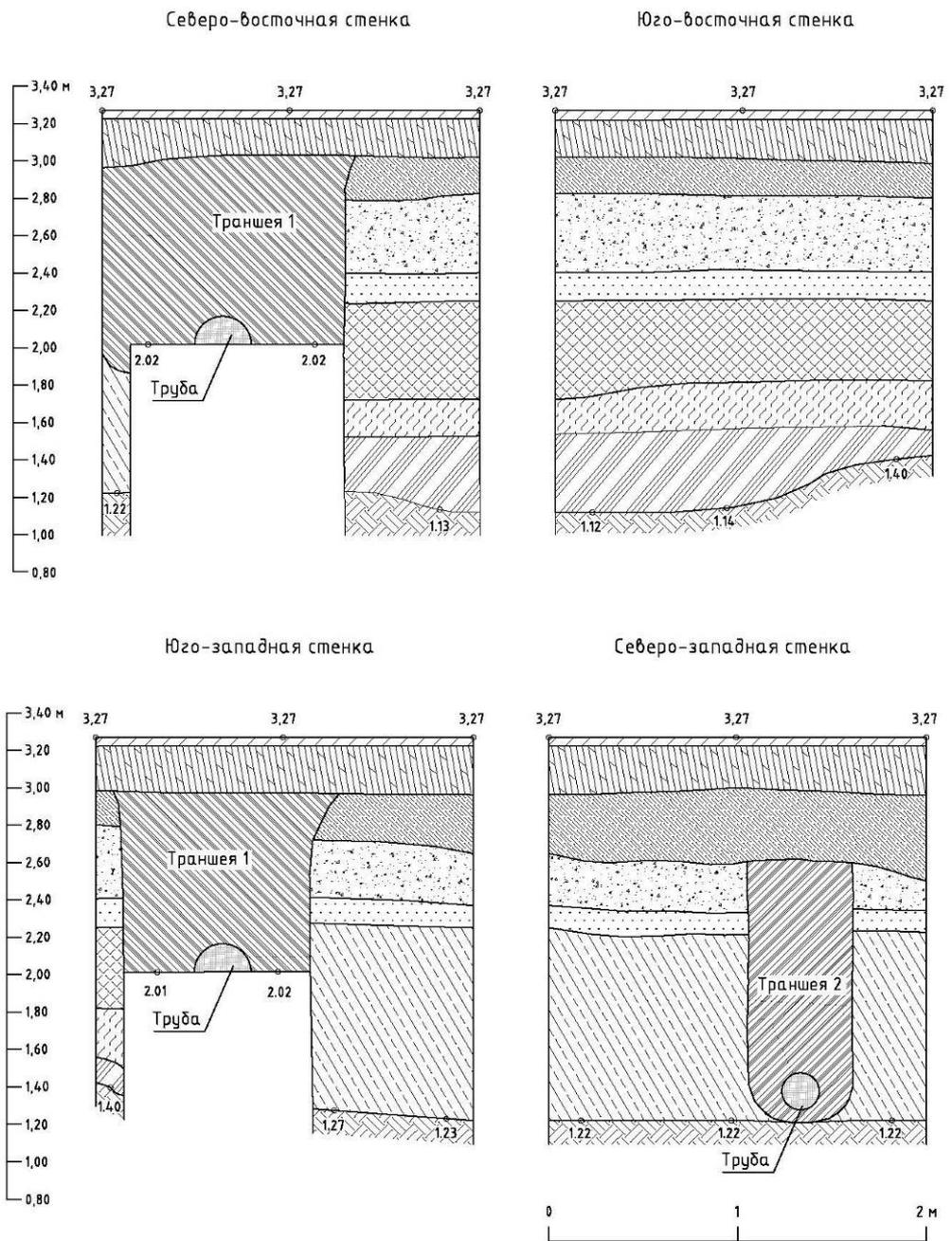
Рис. 38. Санкт-Петербург, Инструментальная улица, дом 3. Шурф 1. Чертежи стенок шурфа
