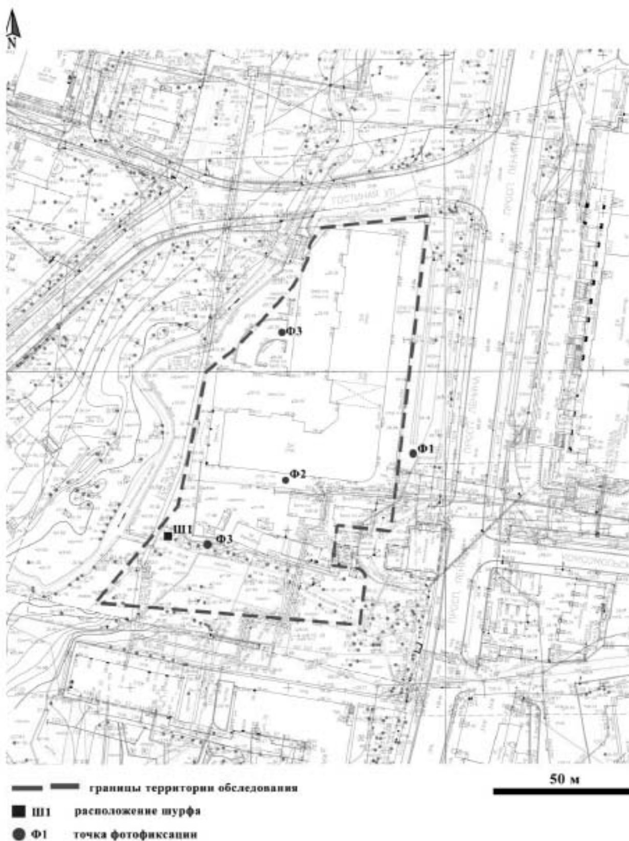
Рис. 13. г. Санкт-Петербург, Курортный район, г. Зеленогорск. Участок с кадастровым номером 78:38:0022464:1148 Местоположение шурфов и зачисток.
