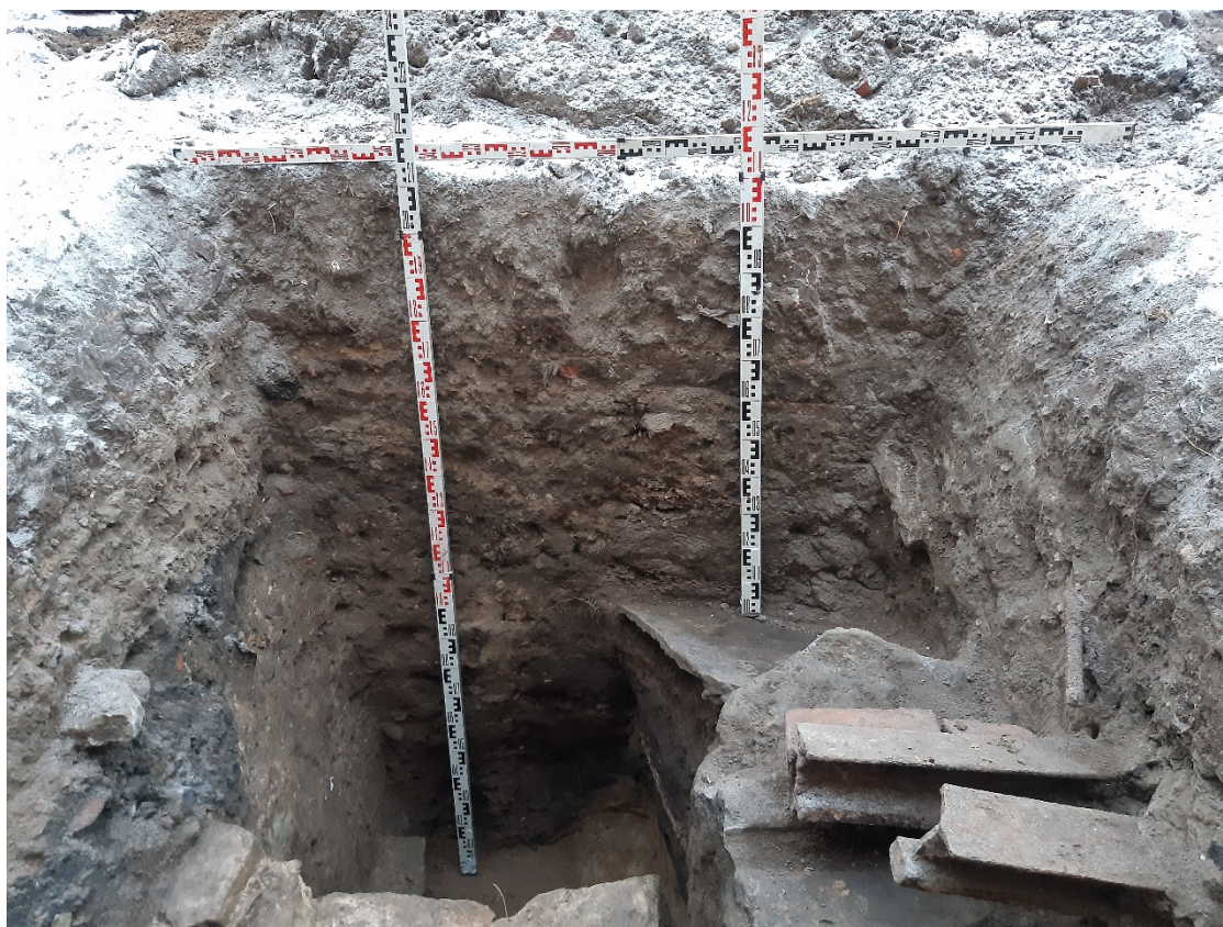
Рис. 28. Санкт-Петербург, Ул. Ленина д. 5 лит. Б. Шурф 1. Фотофиксация стратиграфии северной стенки.
