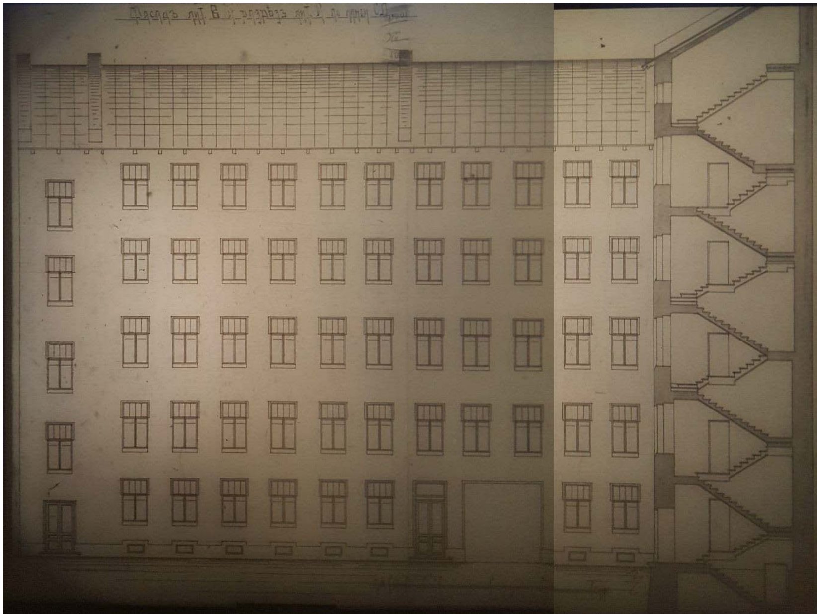
20. Фасад дворового флигеля лит. В и разрез дворового флигеля лит. А по линии СД. 1909 г. ЦГИА СПб. Ф. 513. Оп. 102. Д. 5038.
