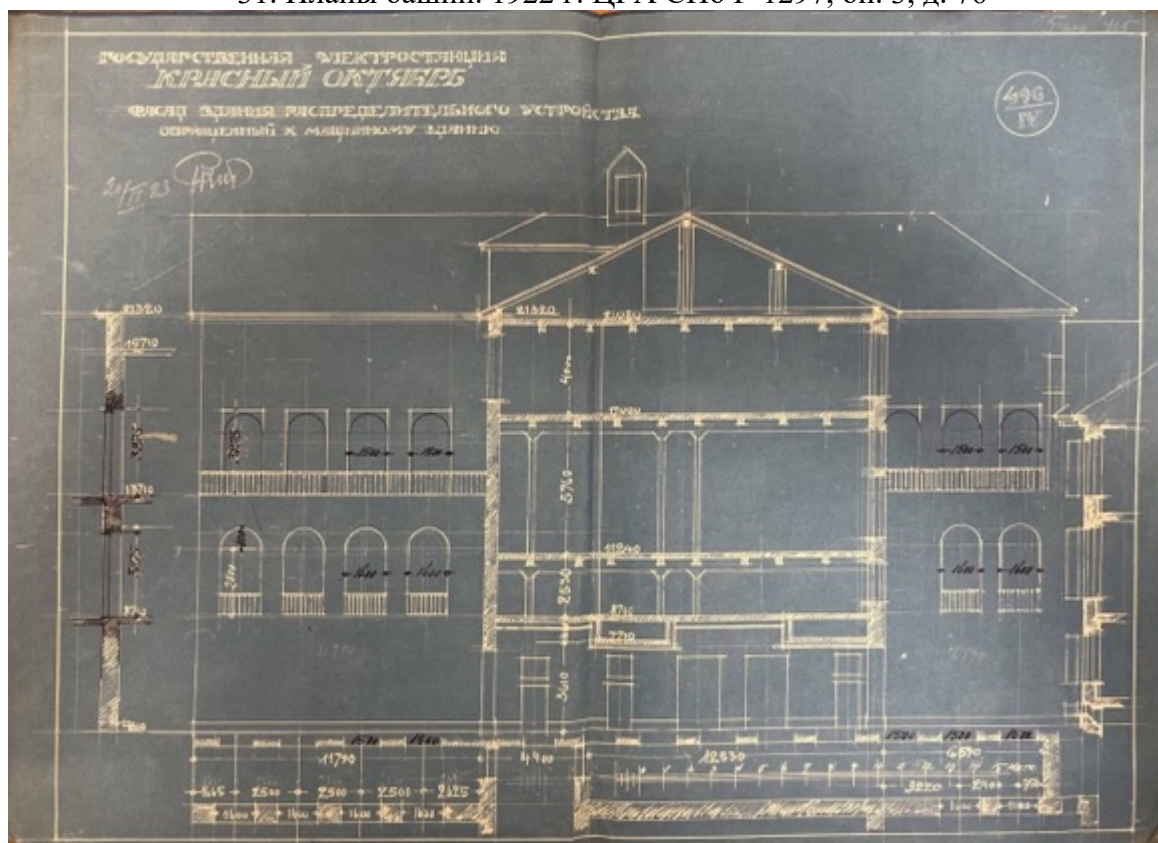
32. Фасад зданий распределительного устройства обращенный к машинному зданию. 1923-1924 гг. ЦГА СПб Р-1297, оп. 5, д. 80
