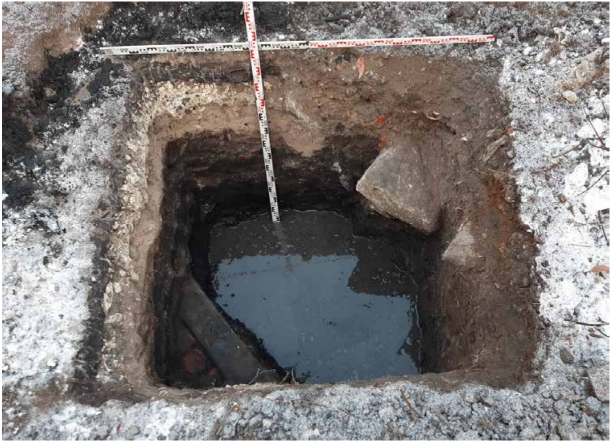
Рис. 40. Санкт-Петербург, набережная реки Волковки, земельный участок 15а (кадастровый номер: 78:13:0007322:1753). Шурф 1. Фотофиксация по затопленному грунтовыми водами материку (светло-серая супесь) – уровень остановки работ. Вид на северо-запад.
