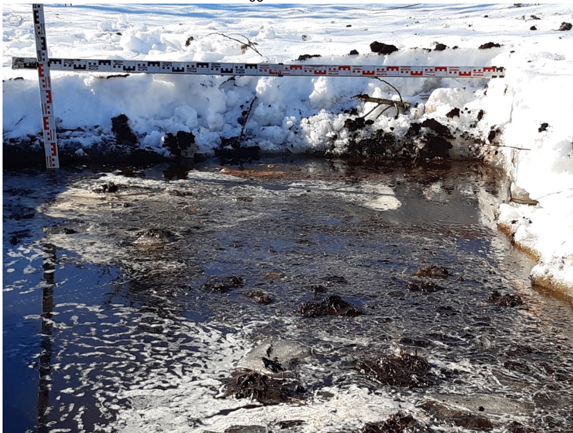
Рис. 44. Санкт-Петербург, п. Парголово, тер. Пригородный (кадастровый номер 78:36:0013262:3851). Шурф 2. Уровень затопления грунтовыми водами.
