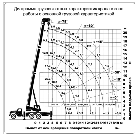
Расчет грузоподъемности автомобильного крана с вылетом стрелы 6.1м
