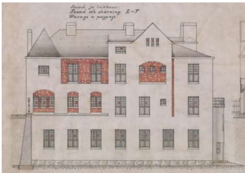
8. Чертежи вокзала станции Ланская. Фасад и разрез по линии E-F. Архитектор Б.Ф. Гранхольм. 1909 г. Национальный архив Финляндии. Rth, rataosasto Ia. 23: Piirustus Lanskajan asemarakennusta varten.
