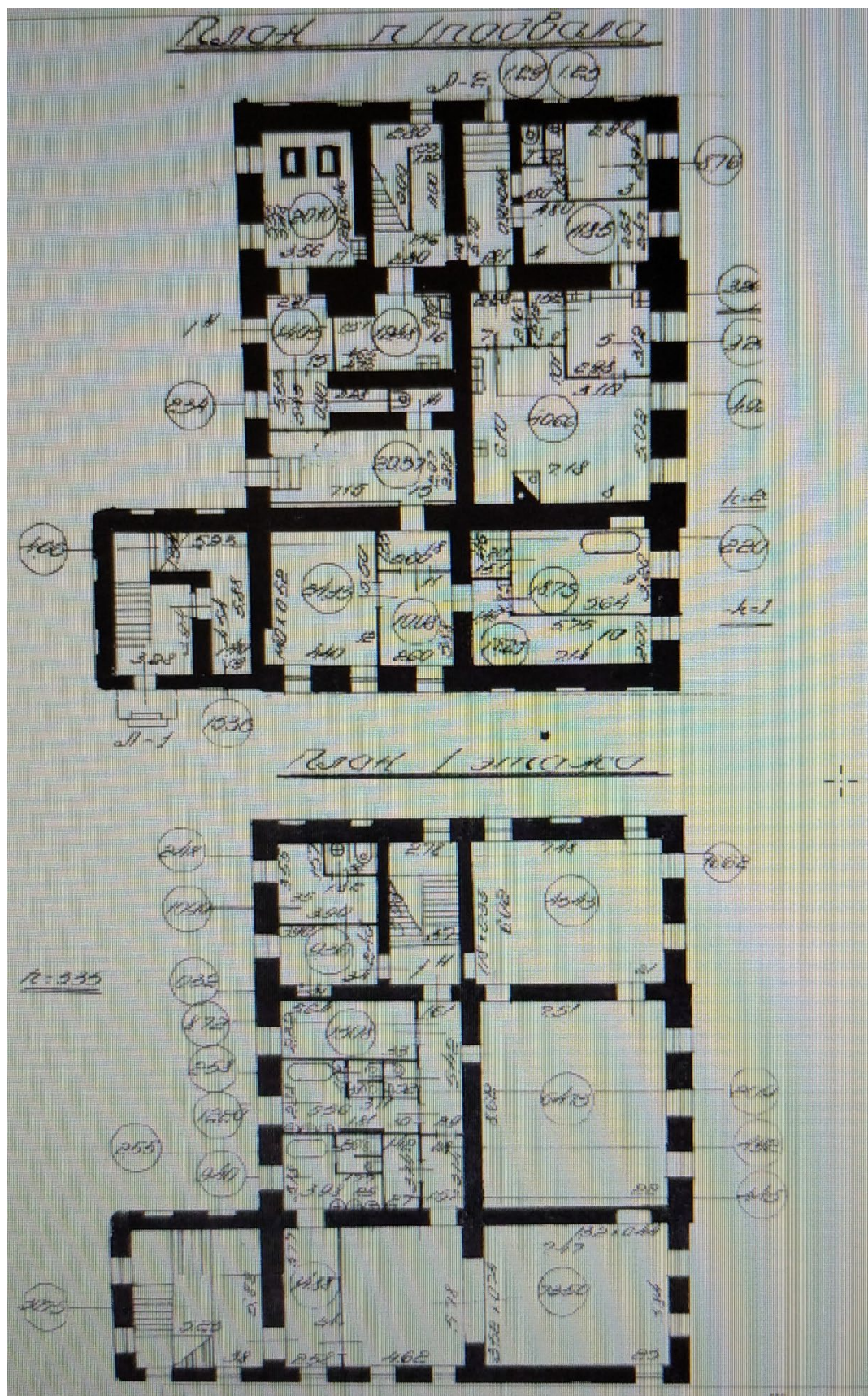
26. Планы подвального (цокольного) и первого этажей. Технический паспорт здания, утвержден 24 ноября 2005 г.
